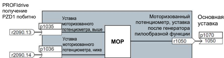
Рис. А-4. Пример: соединение сигналов двух блоков для цифрового входа 0
