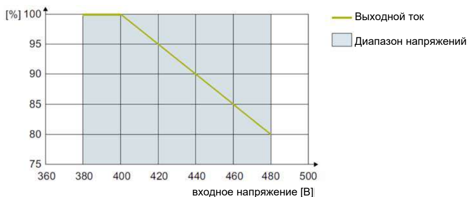
Рис. 11-2. Снижение номинального тока в зависимости от входного напряжения для FSH/FSJ
